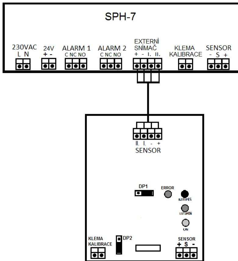
Detektor je vybaven funkcí, která hlídá správné připojení externího snímače SPH-71 na svorky detektoru SPH-7. V případě odpojení externího snímače sepne detektor relé ALARM 1 a ALARM 2 a spustí akustickou signalizaci. V případě, že je detektor nainstalován samostatně bez připojeného externího snímače, tak je nutné do svorek pro připojení externího snímače nainstalovat odpory viz. obr. níže (tovární vybavení detektoru).
