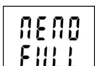
Je-li při necyklickém režimu záznamu paměť zcela zaplněna, záznamník se vypne a na displeji zůstane svítit hlášení MEMO FULL. To platí i v případě, že záznamník je provozován s vypnutým displejem.
