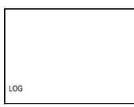
**Je-li displej vypnut**, platí výše popsaná zobrazení až do zobrazení údaje o předpokládané zbývající kapacitě baterie a poté displej zhasne – pro indikaci stavu „záznamník zapnut“ zůstává svítit symbol LOG, který bliká, pokud zaplnění paměti naměřených hodnot překročí 90%.
