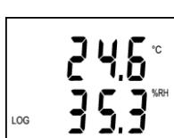
**Je-li zapnut displej**, následuje zobrazení naměřených hodnot - na horním řádku displeje se zobrazuje okolní teplota (°C), na dolním řádku relativní vlhkost vzduchu (%RH). Symbol LOG indikuje probíhající záznam – jestliže bliká, je paměť naměřených hodnot zaplněna více než z 90%.
