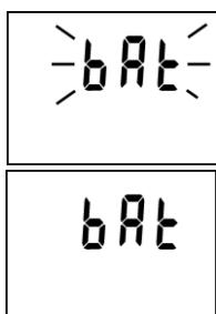
Zobrazuje-li se periodicky nápis BAT na horním rádku displeje (vždy na 1 s s intervalom 10 s), je tímto indikováno ukončení předpokládané životnosti baterie – přístroj je však nadále funkční v plném rozsahu. Baterii je vhodné co nejdříve vyměnit!
