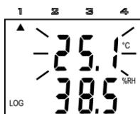
Aktivní alarm je indikován (je-li displej zapnut) blikáním hodnoty příslušné veličiny na displeji a současným rozsvícením šipky v horní části displeje, přičemž šipka 1 indikuje aktivní alarm pro okolní teplotu, šipka 2 relativní vlhkost a šipka 4 teplotu rosného bodu.
