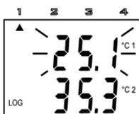
Aktivní alarm je indikován (je-li displej zapnut) blikáním hodnoty příslušné veličiny na displeji a současným rozsvícením šipky v horní části displeje, přičemž šipka 1 indikuje aktivní alarm pro teplotu 1. kanálu, šipka 2 teplotu 2. kanálu, šipka 3 kanál IN3 a šipka 4 kanál IN4.
