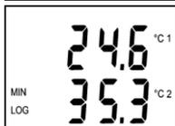
Zapnutý záznamník neustále (s intervalem 10 s) aktualizuje paměť minimální a maximální hodnoty jednotlivých veličin. Je-li zapnuto zobrazení hodnot MIN/MAX, zobrazí se nyní postupně minimální naměřené hodnoty (na displeji indikováno nápisem MIN) a poté podobně maximální naměřené hodnoty všech veličin (na displeji indikováno nápisem MAX). Celý cyklus se pak periodicky opakuje, tzn. že následuje opět zobrazení aktuálně naměřených hodnot.
