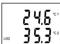
**Je-li zapnut displej**, následuje zobrazení naměřených hodnot – na horním řádku displeje se zobrazuje teplota 1. kanálu (°C 1), na dolním řádku teplota 2. kanálu (°C 2). Symbol LOG indikuje probíhající záznam – jestliže bliká, je paměť naměřených hodnot zaplněna více než z 90%.
