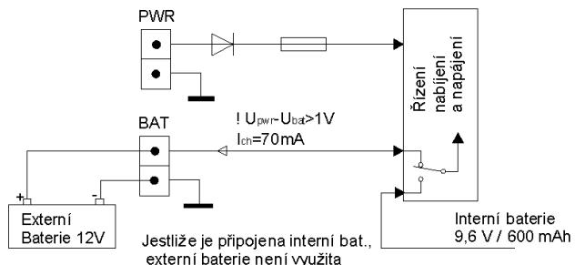
**Nepřipojte externí baterii jinou než dobíjecí s jmenovitým napětím 12 V!**
